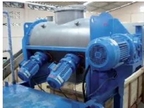
Ce n'est pas compliqué techniquement mais il faut de la rigueur. En utilisant un mélangeur, une quantité connue de sel et de solution de KF sont introduites. A la sortie on a un produit parfaitement mélangé.
